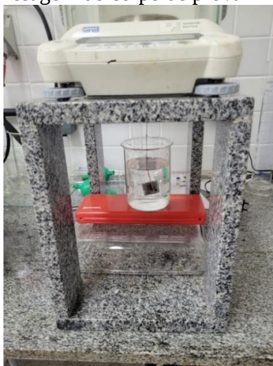
Figura 13 - Pesagem do corpo de prova imerso na água.
