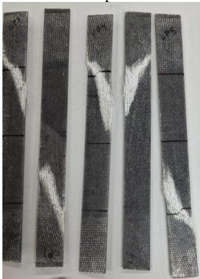
Figura 18 - CPs de PRFV+1% após o ensaio de tração uniaxial.
