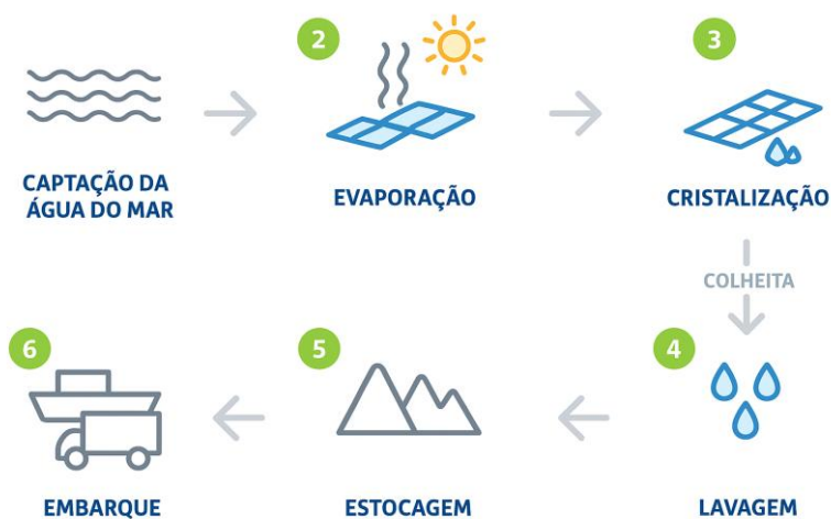
Figura 3 - Processo produtivo do sal marinho
