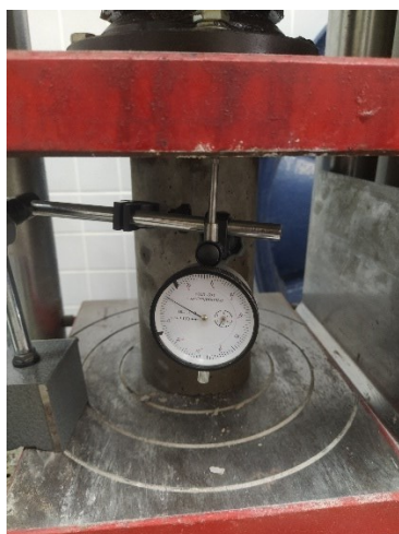
Figura 22 - Suporte magnético e relógio comparador
