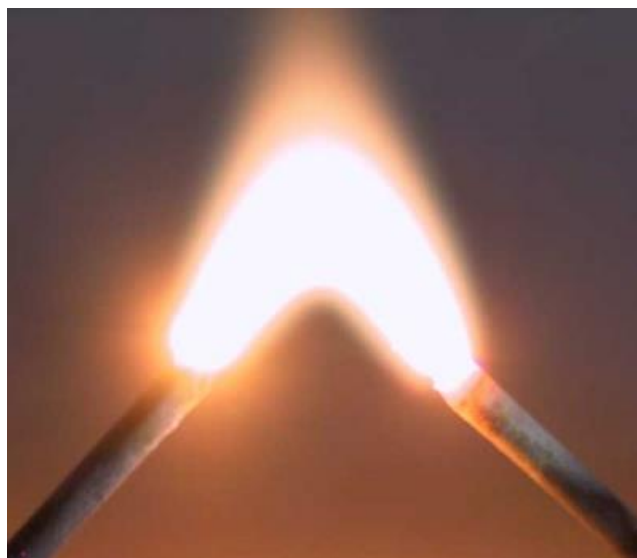
Figura 9 - Arco voltaico entre dois bastões de carvão
