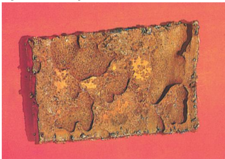
Figura 5 - Corrosão por Placas.
