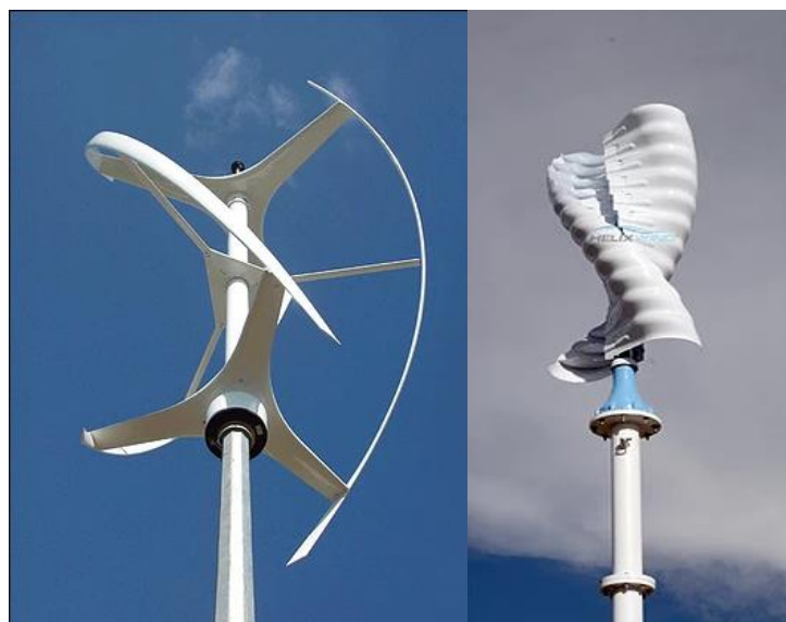
Figura 3: Aerogerador de eixo vertical do tipo Darrieus (a) e do tipo Savonius (b).
