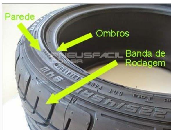
Figura 4 – Camadas de borracha no pneu
