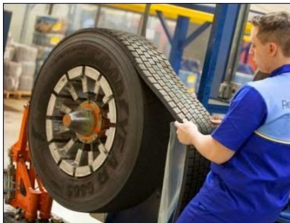
Figura 5 – Aplicação da nova banda de rodagem
