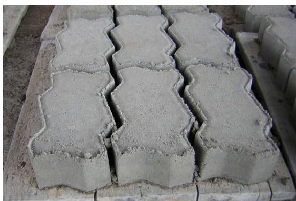
Figura 14 – Pavers (piso) de concreto com adição de borracha
