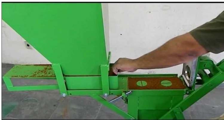
Figura 9 - Moldagem dos tijolos
