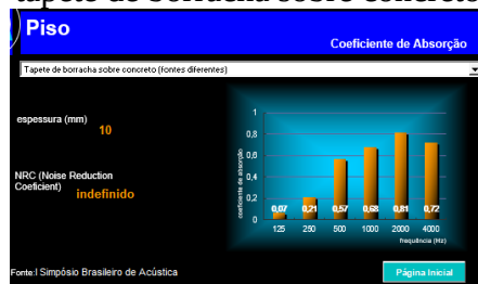
Figura 75: Piso geral em tapete de borracha sobre concreto
