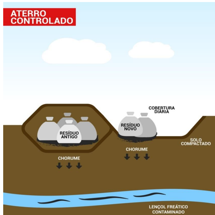
Figura 7: Esquema aterro controlado
