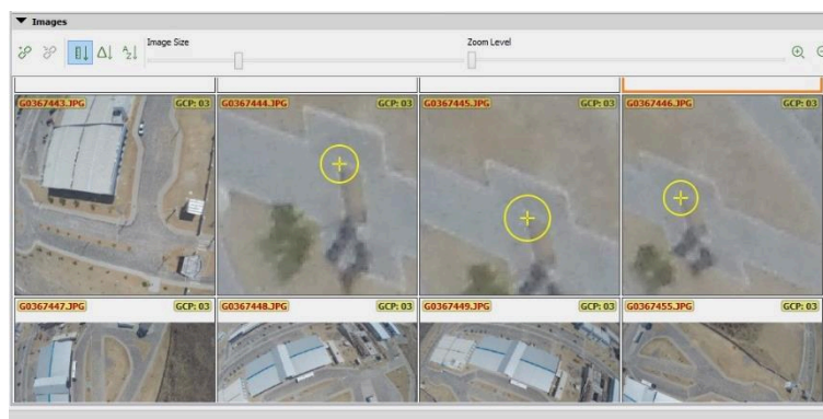
Figura 16 - Identificação de pontos de controle.
