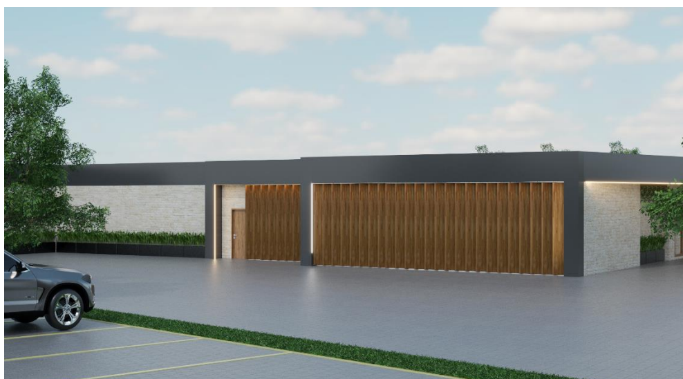
Figura 69 – Utilização de brises como estratégia de sombreamento das aberturas de vidro.
