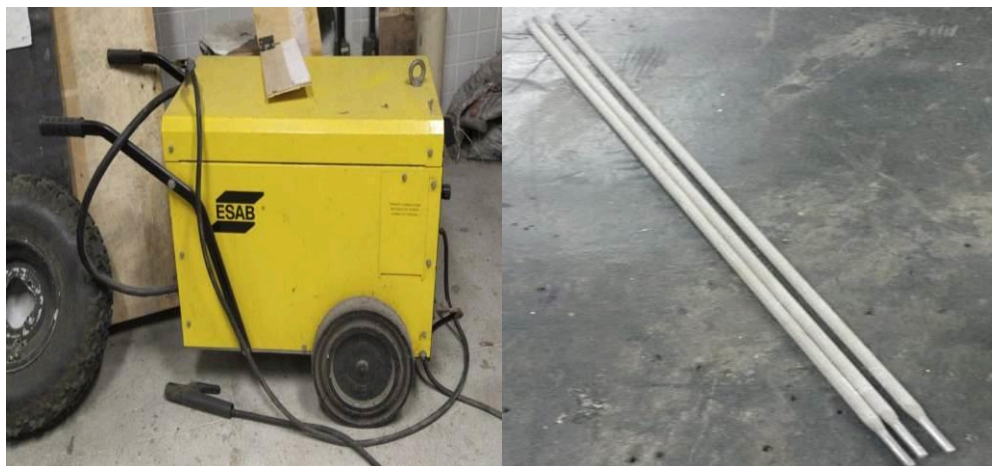
Figura 11: Equipamento usado para a soldagem.
