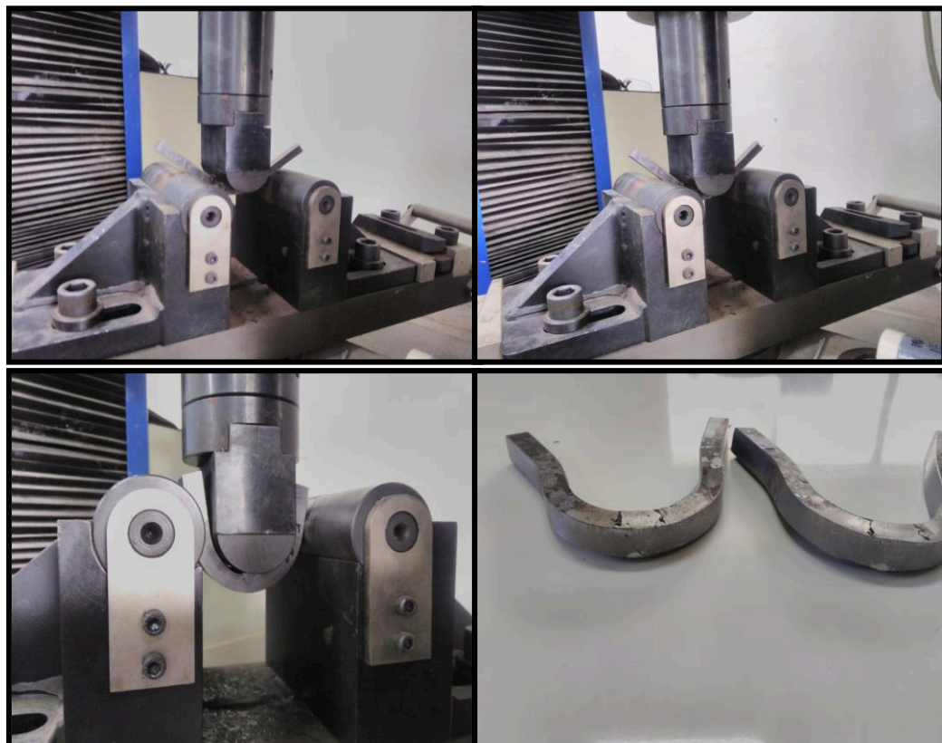
Figura 13: Sequência do ensaio de dobramento realizado nos corpos de prova e angulação final do corpo de prova após passar pelo processo de dobramento.
