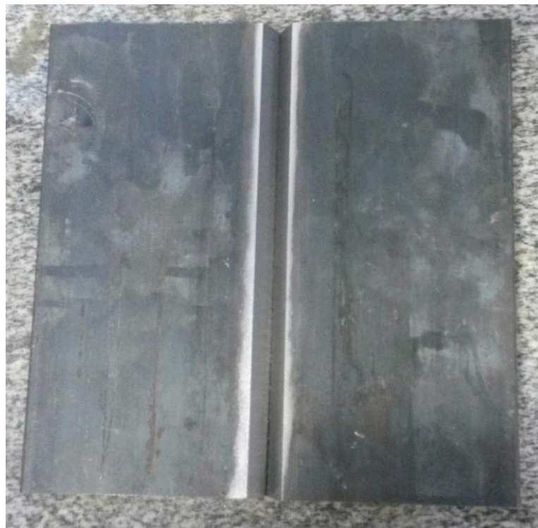
Figura 9: Chapas de aço usinadas e simetricamente alinhadas para formação do corpo de prova.
