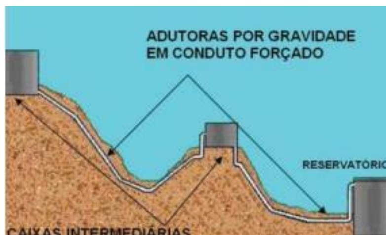
Figura 3 – Adutora por gravidade em conduto forçado
