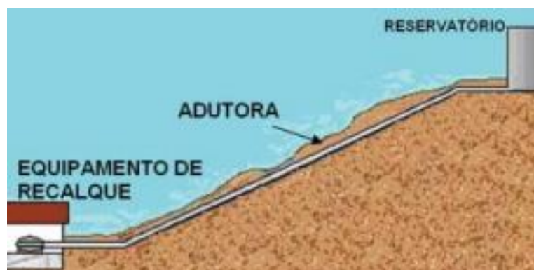
Figura 4 – Adutora por recalque
