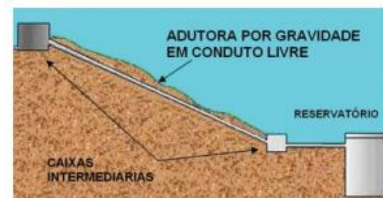
Figura 2 – Adutora por gravidade em conduto livre
