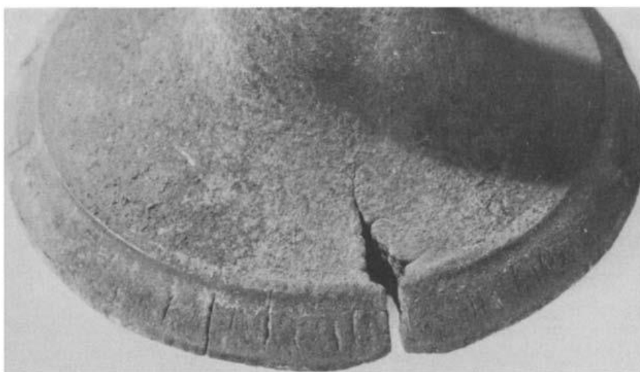
Figura 4 - Rachadura por fadiga térmica em válvula de escape de motor.
