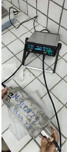
Figura 10 - Determinação de velocidade de propagação de onda ultrassônica.
