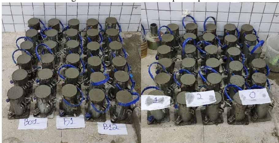
Figura 6 - Cura inicial dos corpos de prova.
