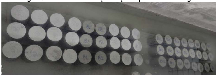
Figura 7 - Cura final dos corpos de prova por imersão em água.
