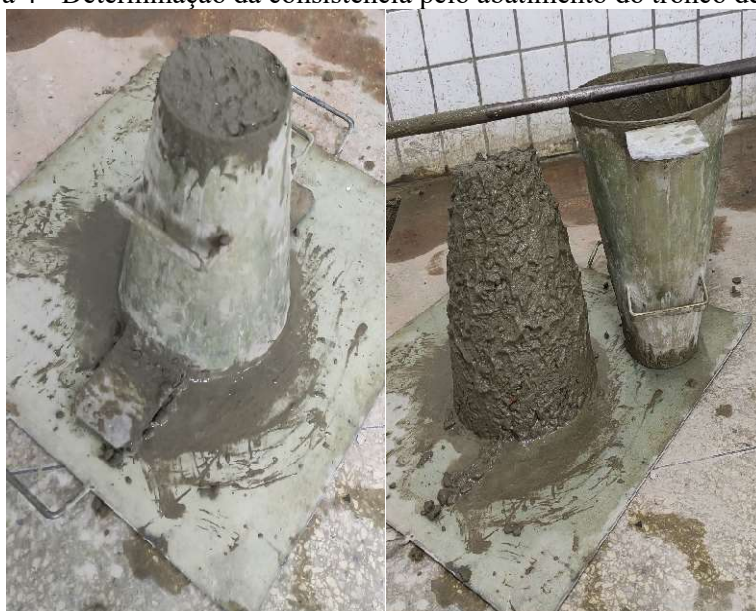
Figura 4 - Determinação da consistência pelo abatimento do tronco de cone.
