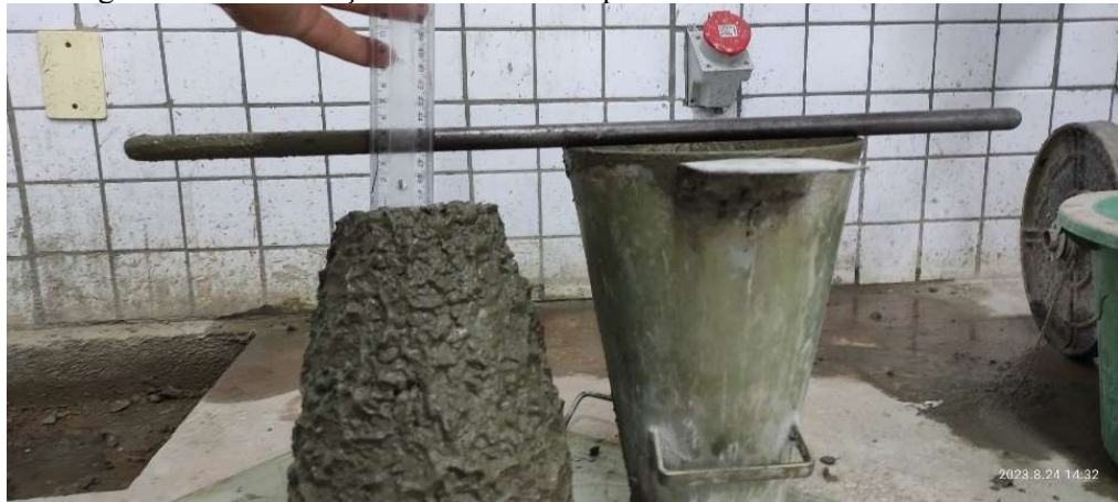
Figura 5 - Determinação da consistência pelo abatimento do tronco de cone.
