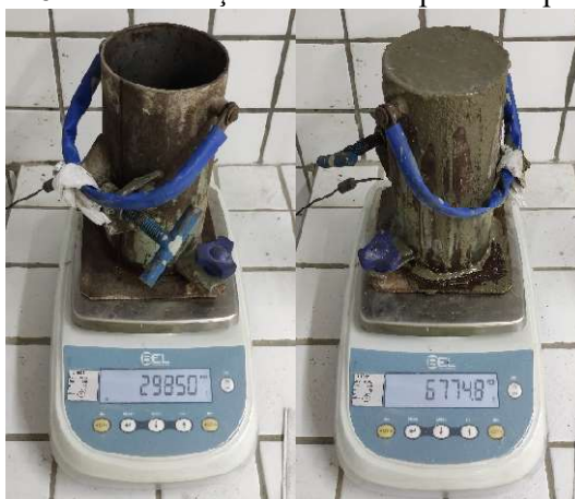
Figura 8 - Determinação da massa específica aparente.
