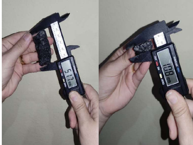
Figura 2 - Determinação de índice de forma pelo método do paquímetro.
