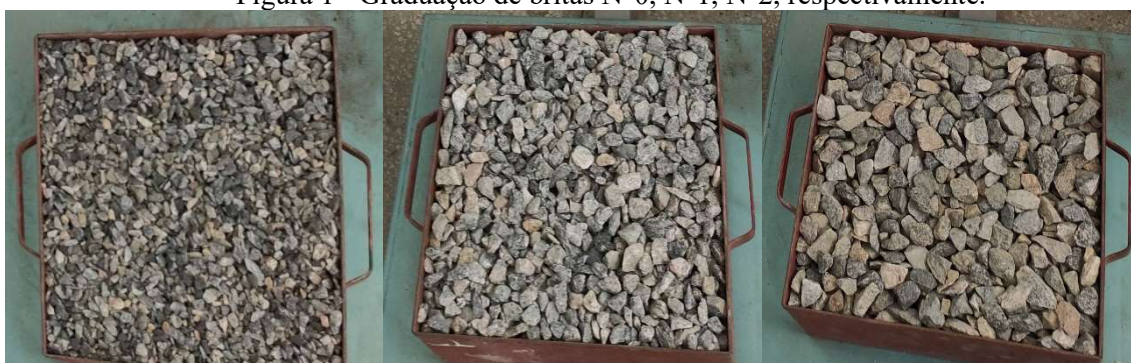
Figura 1 - Graduação de britas N°0, N°1, N°2, respectivamente.
