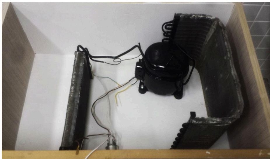
Figura 14: Arranjo dos componentes do ar condicionado.
