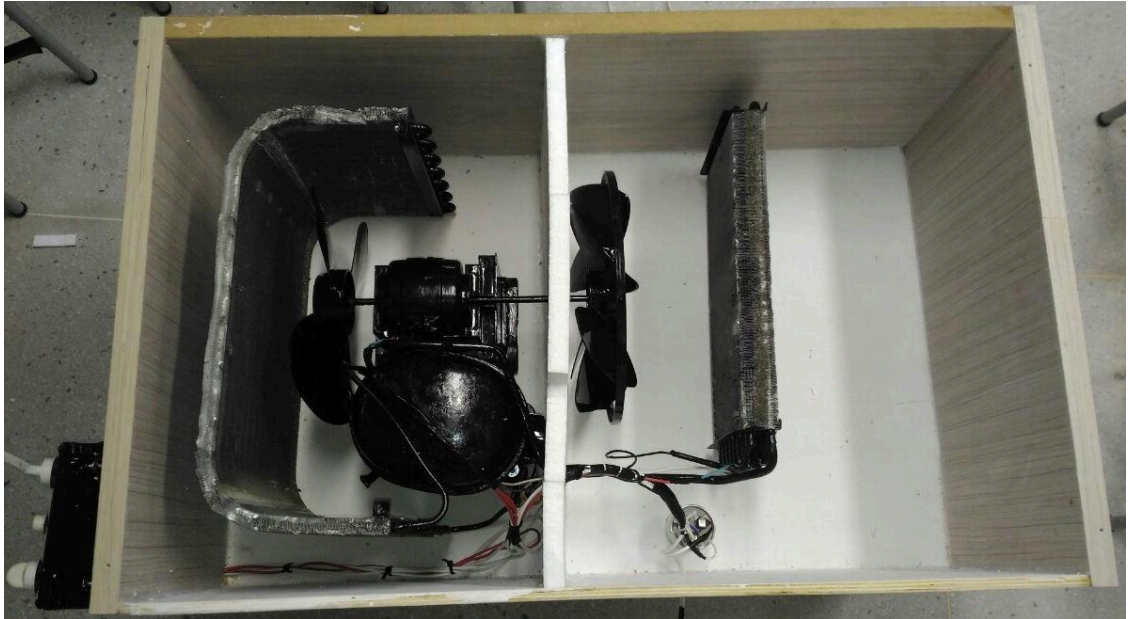
Figura 16: Parede de isopor para separar termicamente o evaporador do compressor
