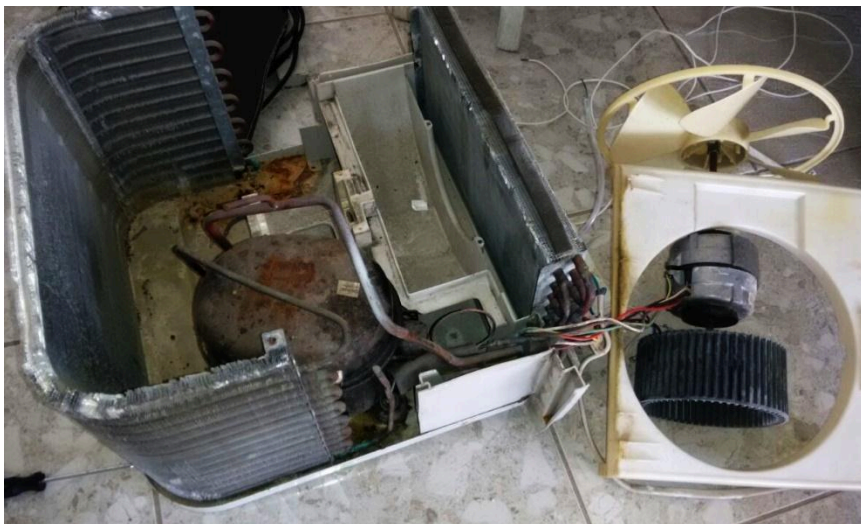
Figura 10: Estado inicial do ar condicionado
