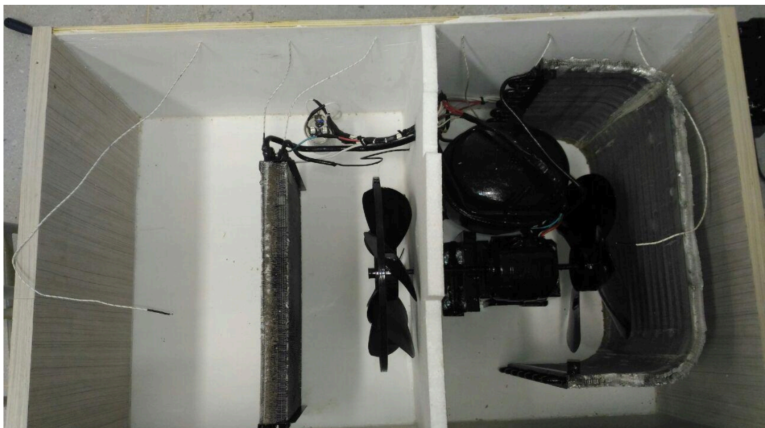
Figura 17: Posicionamento dos termopares.
