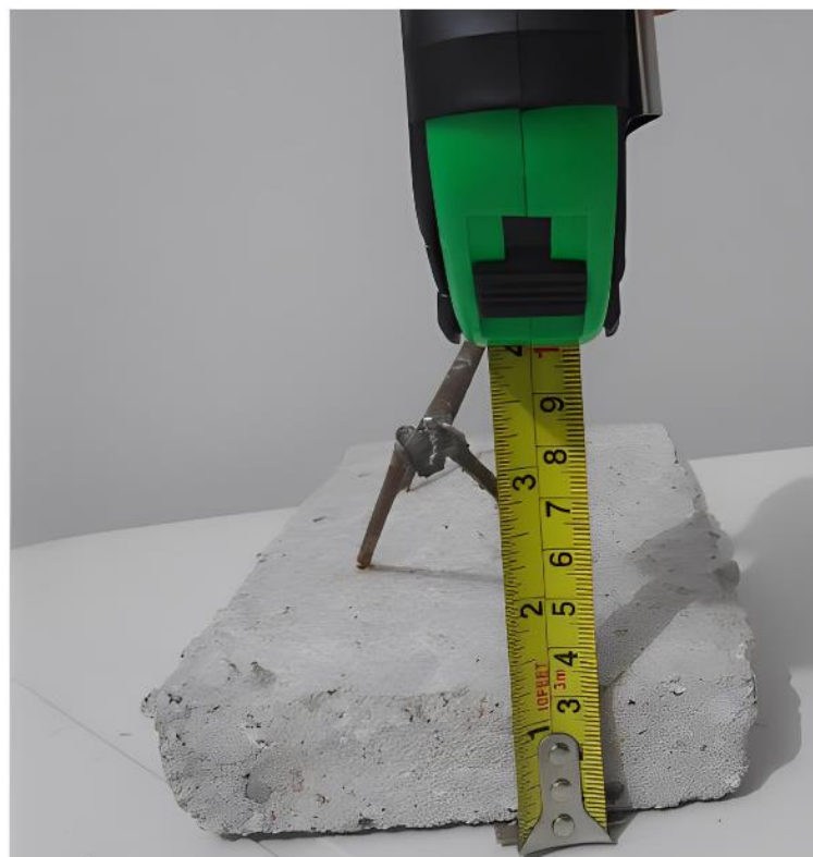
Figura 10: Medição da Altura da Trelça Espacial.
