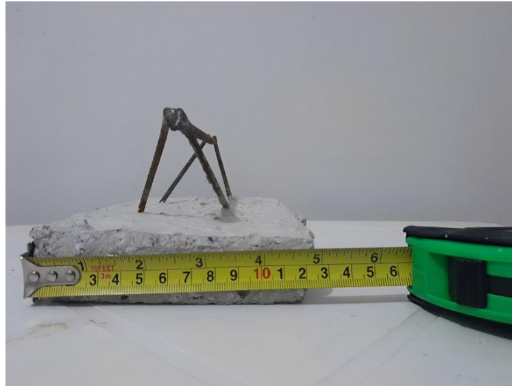
Figura 9: Medição do Comprimento da Trelça Espacial
