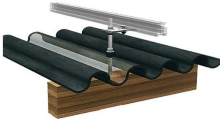
Figura 6 - Modo de fixação em telhas de fibrocimento
