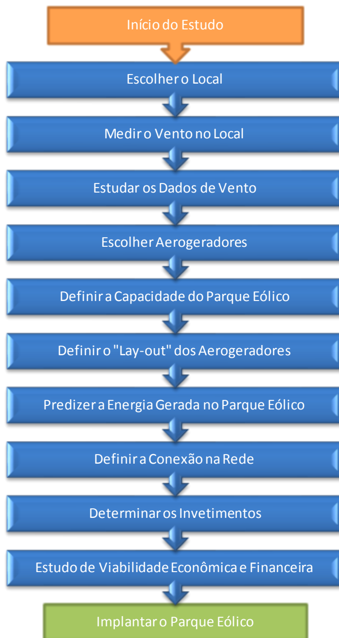
Figura 16 – Esquema de implantação de um parque eólico.
