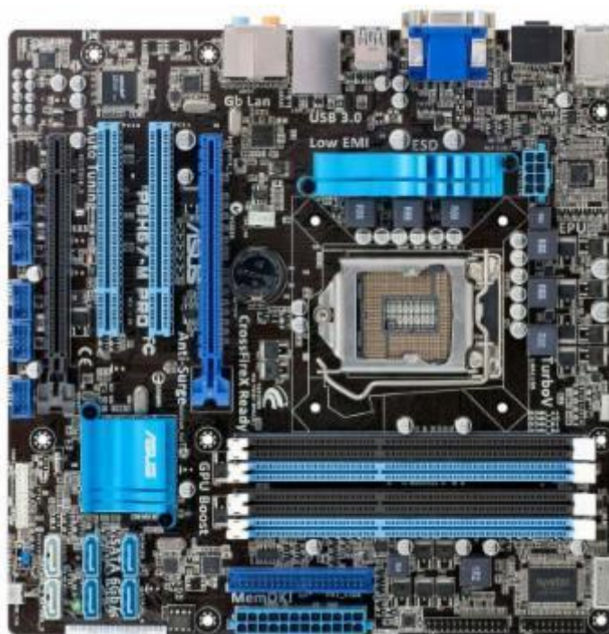
Figura 5 – Placa mãe de um computador
