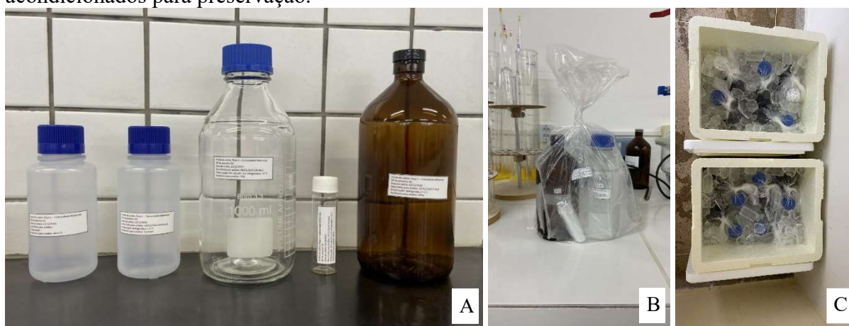
Figura 3 – Frascos empregados nas campanhas de amostragem: a) etiquetados; b) selados; e c) acondicionados para preservação.
