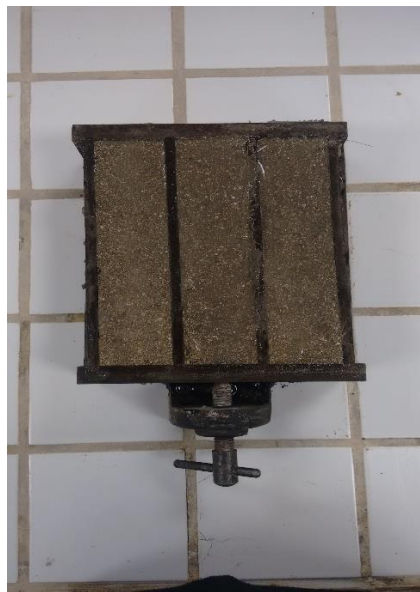
Figura 22. Moldagem dos corpos de prova para os ensaios de resistência.
