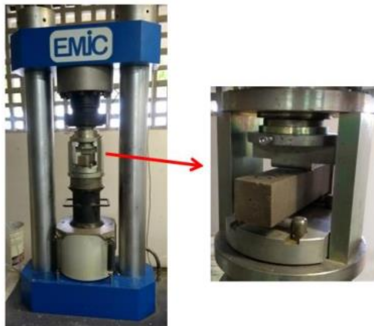
Figura 23. Ensaio de resistência à tração na flexão.
