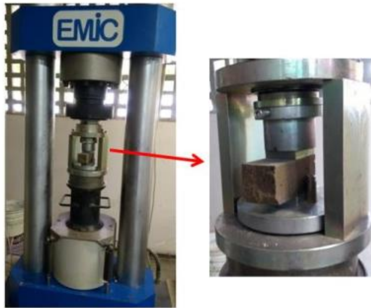
Figura 24. Ensaio de resistência à compressão.
