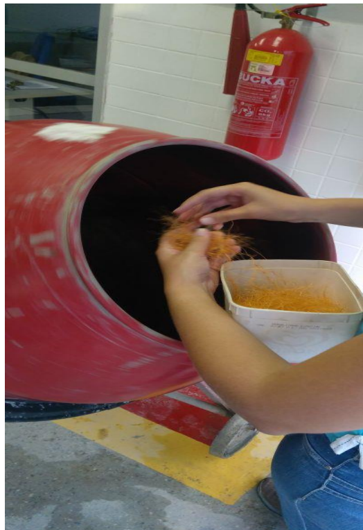
Figura 14. Incorporação das fibras de sisal.
