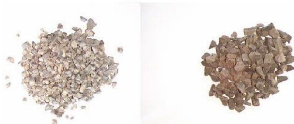
Figura 3: Agregado graúdo: brita granítica.
