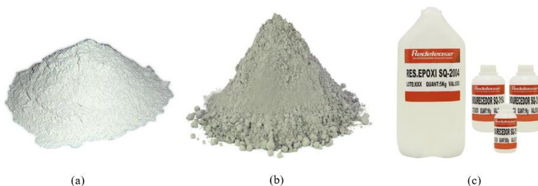
Figura 1: (a) cal, (b) cimento Portland e (c) resina epóxi.
