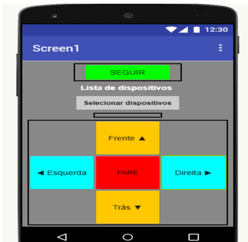
Figura 8 - Interface do controle do robô TAN.
