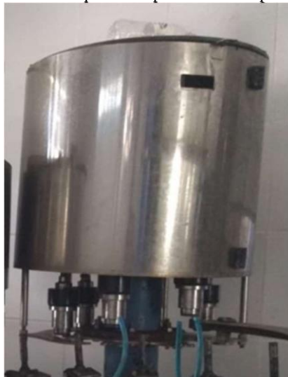
Figura 19: Máquina tampadora ou rosqueadora
