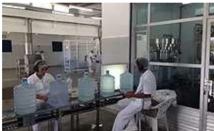
Figura 9: Inspeção e lacre
