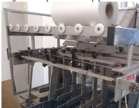
Figura 23: Empacotadora com papel laminado
