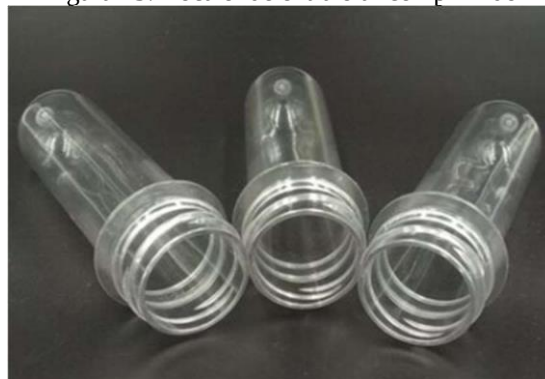
Figura 13: Boca onde entra o ar comprimido
