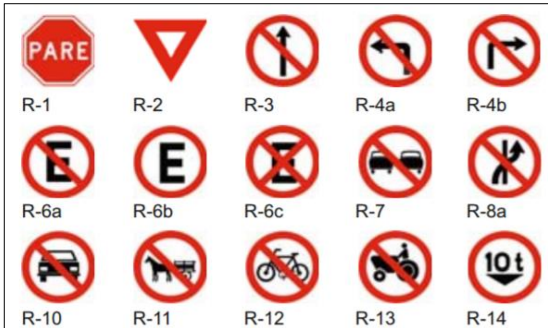
Figura 3: Exemplos de sinais de regulamentação.
