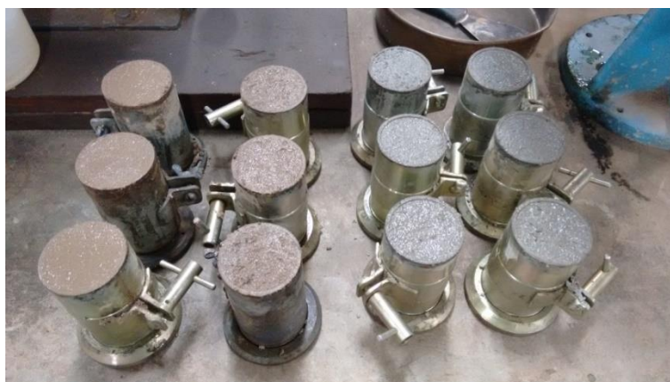
Figura 13: Moldagem dos corpos de prova
