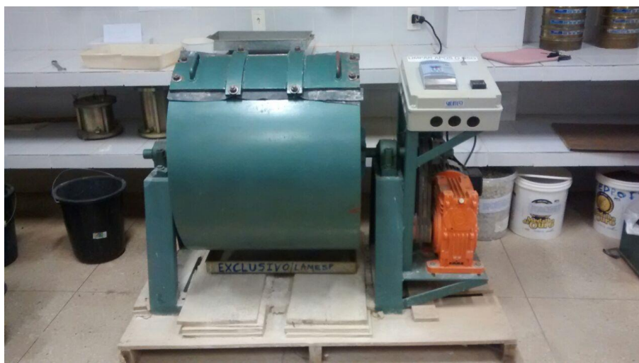
Figura 5: Aparelho de Ensaio de Abrasão de Los Angeles
