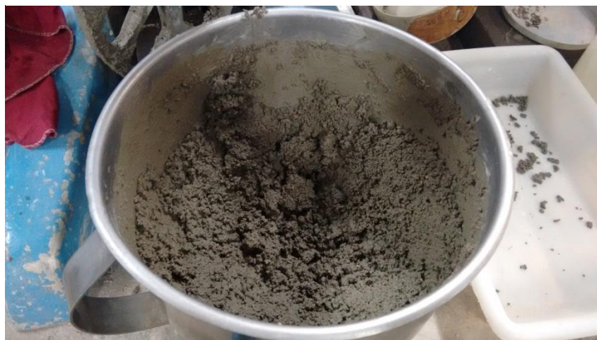
Figura 11: Argamassa de Referência
