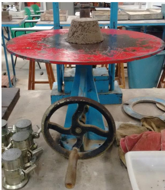
Figura 12: Ensaio de Índice de Consistência Normal
