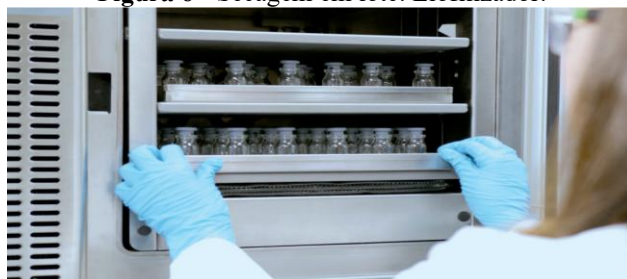
Figura 6 - Secagem em lote: Liofilizador.
