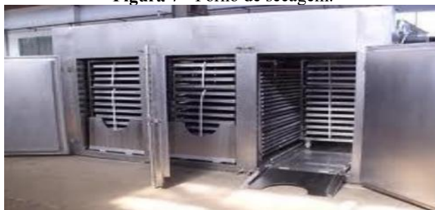
Figura 7 - Forno de secagem.
