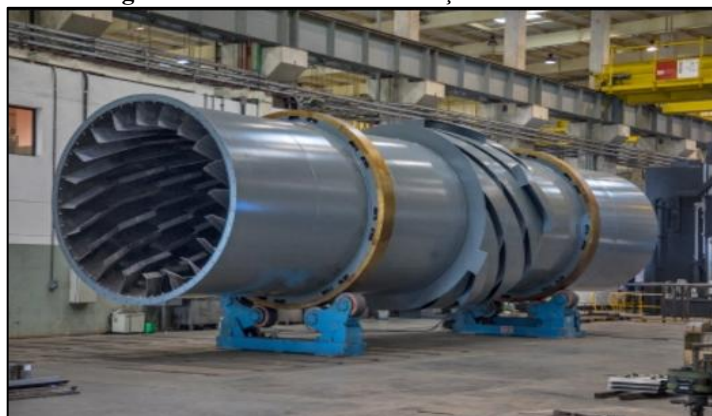
Figura 9 - Secador rotativo de açúcar e biomassa.
