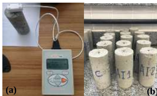
Figura 04: KD2PRO e Corpos de prova para determinação da condutividade térmica. (Autoria própria)
