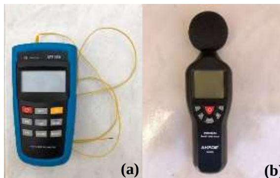
Figura 08: Conjunto aparelho-termopar e Medidor de nível sonoro, respectivamente. (Autoria própria)
