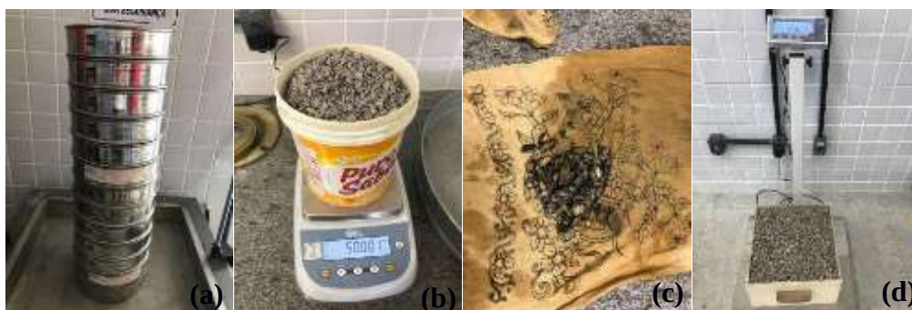
Figura 02: Caracterização agregado graúdo. (Autoria própria)
