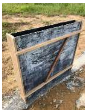
Figura 06: Fôrma utilizada para a moldagem dos modelos. (Autoria própria)
