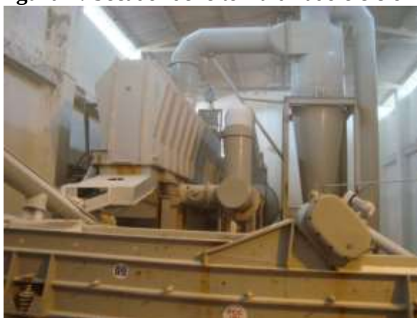
Figura 7: Secador de leito fluidizado e ciclones
