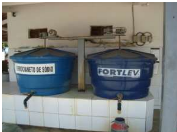
Figura 10: Área de diluição e preparo dos aditivos (Iodato de Potássio e Ferrocianeto de Sódio) (A) e Rotâmetros (Flowmeter) – Controladores de Vazão (B).
