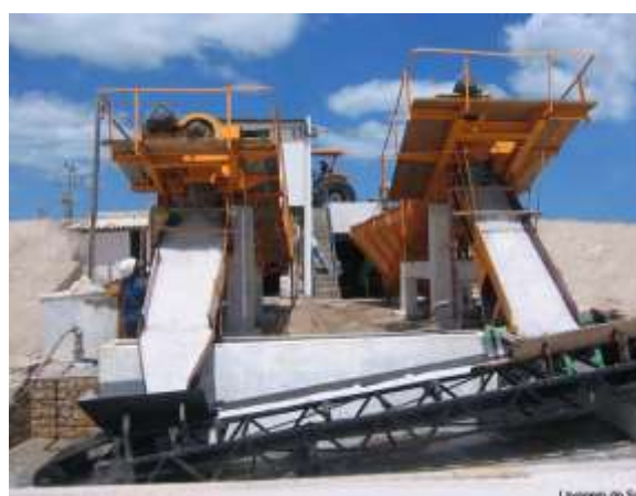
Figura 5: Sistemas de Lavagem (A) e Lavadores Horizontais (B)
