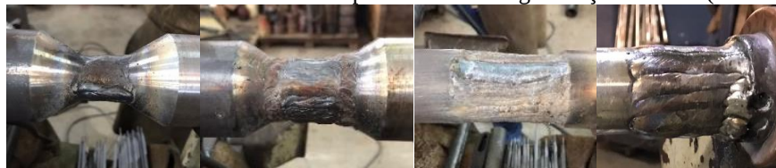
Figura 14 – Eixo de induzido sendo emendado por solda em tarugo de aço inox 304 (De autoria própria)
