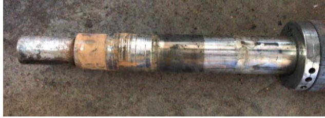
Figura 06 – Eixo de induzido cisalhado (De autoria própria)
