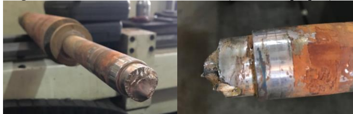
Figura 06 – Eixo de induzido cisalhado (De autoria própria)
