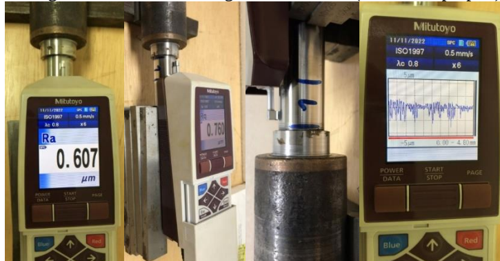
Figura 16 – Análise de rugosidade no CP1 (De autoria própria).
