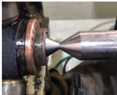
Figura 13 – Preparo do eixo para receber a solda (De autoria própria).
