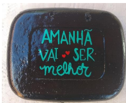
Figura 15: Placa lisa e pintada com material de conchas de mariscos trituradas e caixas de leite longa vida trituradas.
