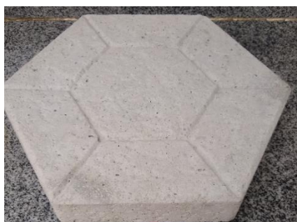
Figura 13: Bloco ecológico de concha, cimento e caixa de leite longa vida.
