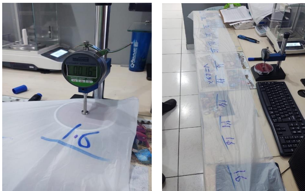
Figura 13 - Medição no micrômetro e verificação de espessura ao longo do filme
