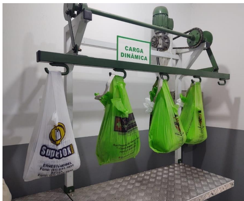
Figura 12 - Ensaio da carga dinâmica
