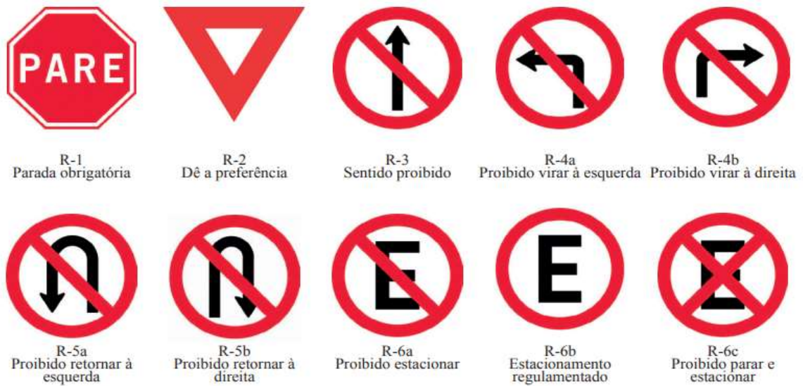
Figura 11: Placas de regulamentação
