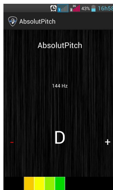
Figura 14 – Corda Ré pouco desafinada abaixo da frequência fundamental
