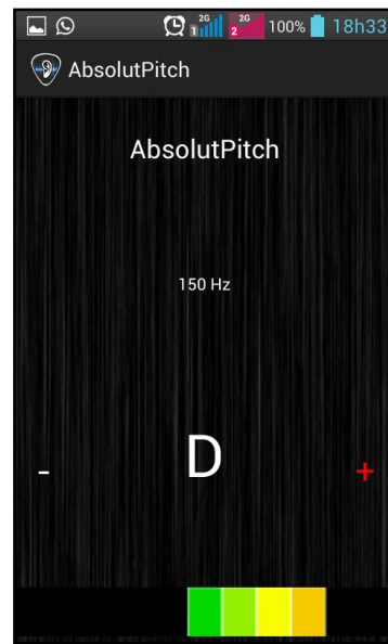
Figura 15 – Corda Ré pouco desafinada acima da frequência fundamental
