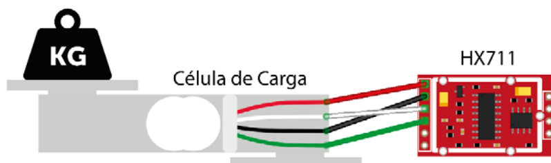
Figura 2: Circuito e funcionamento do conjunto célula de carga com o módulo HX711. (Autoria Própria)
