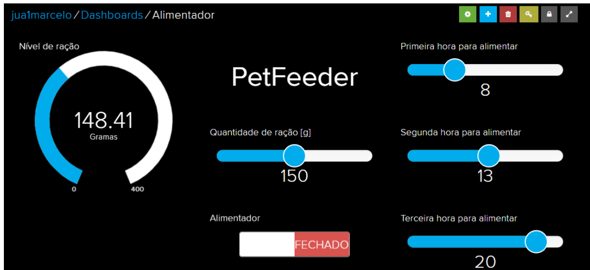
Figura 5: Dashboard da interface na plataforma Adafruit.IO do alimentador inteligente automático PetFeeder. (Autoria Própria)
