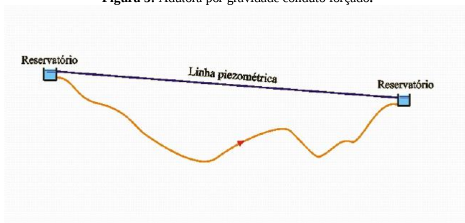
Figura 3: Adutora por gravidade conduto forçado.
