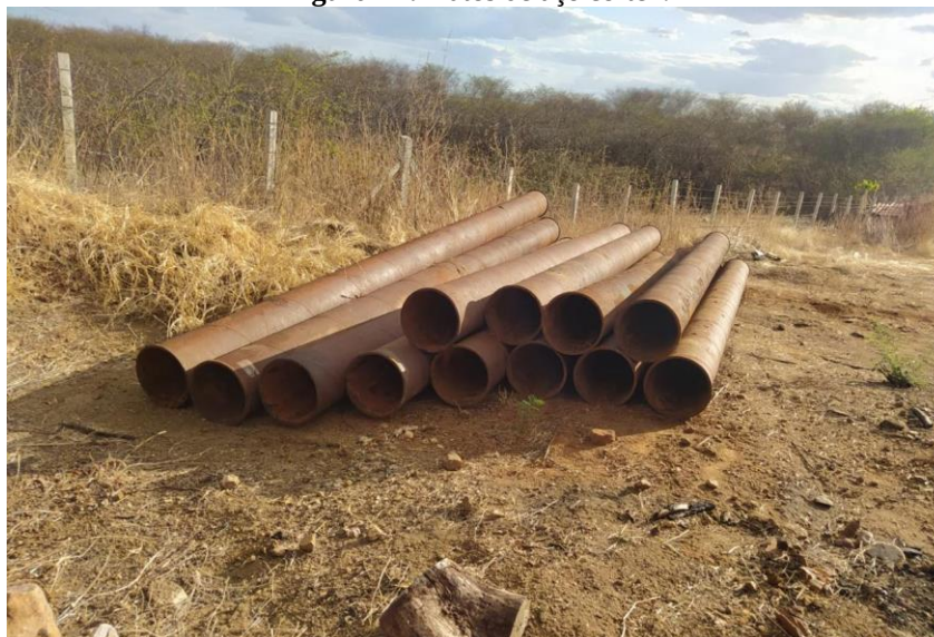
Figura 12: Dutos de aço corten.
