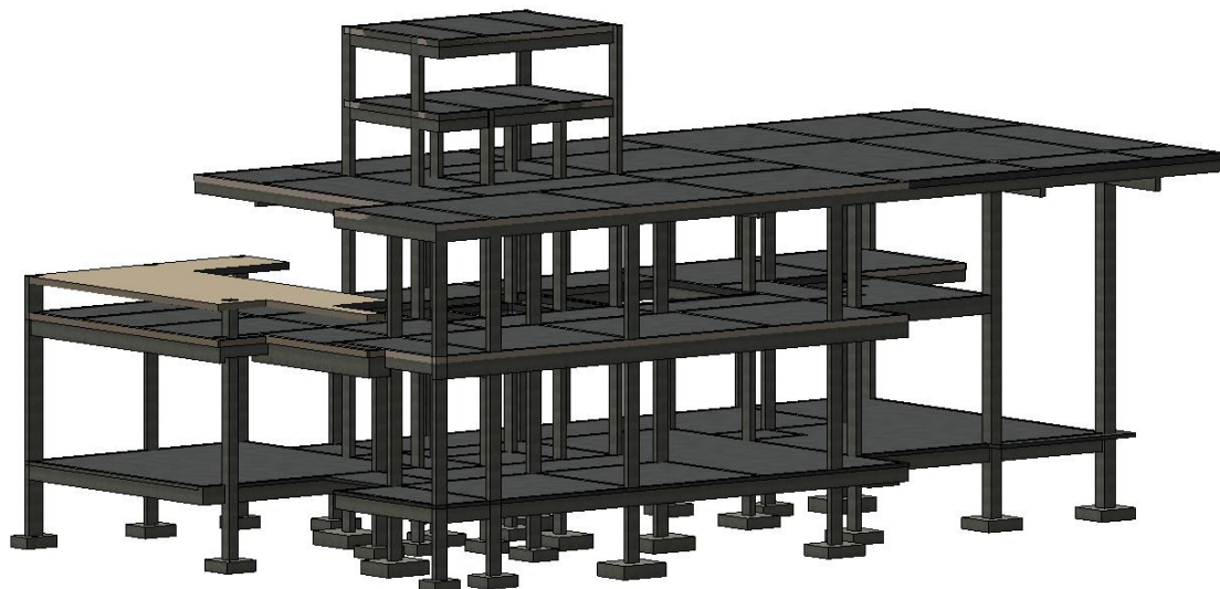
Figura 6 – Projeto estrutural da residência em estudo.
