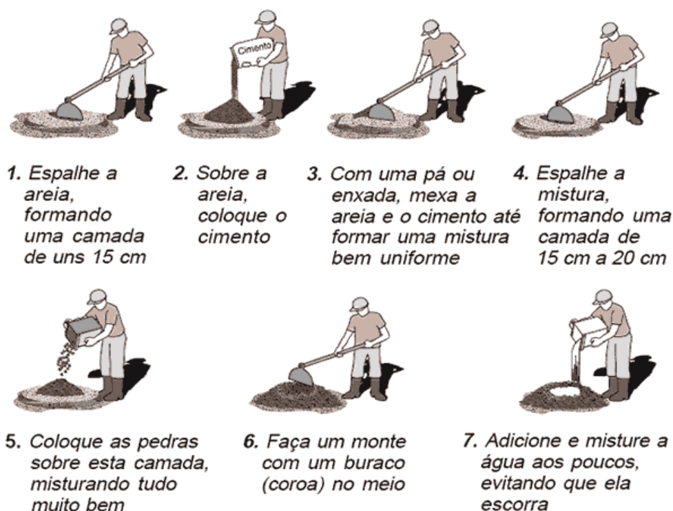
Figura 4– Mistura do Concreto.
