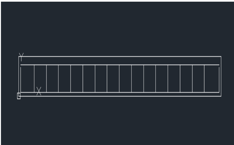
Figura 31– Armadura positiva e negativa
