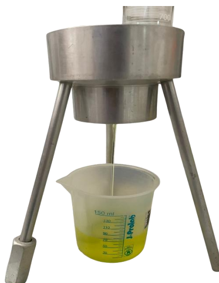
Figura 3: Determinação da viscosidade do lava-louças neutro utilizando o copo ford
