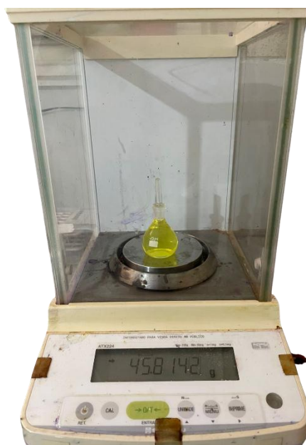
Figura 4: Determinação da densidade do lava-louças neutro.
