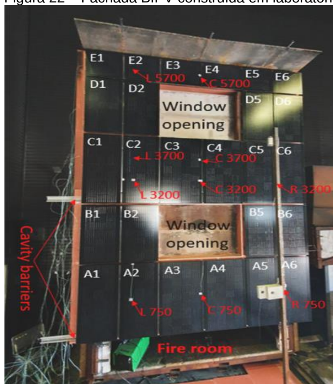
Figura 22 – Fachada BIPV construída em laboratório
