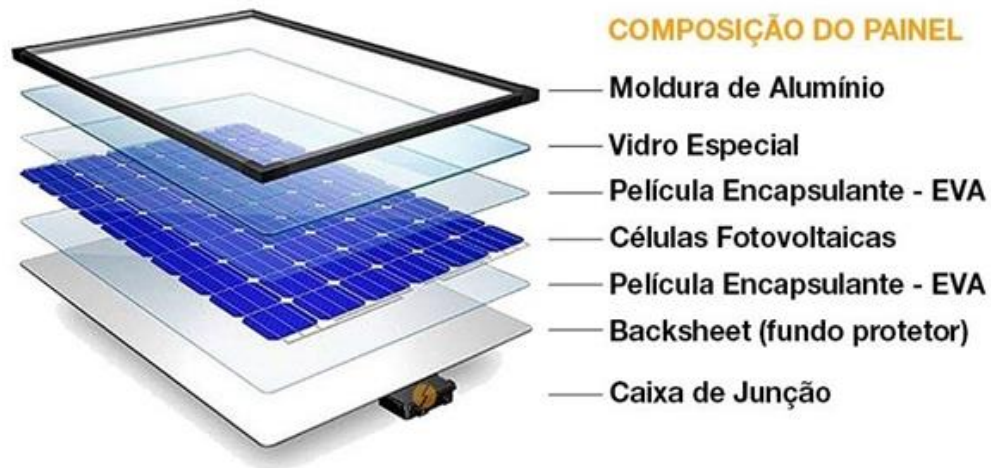
Figura 27 – Camadas constituintes de um painel solar padrão
