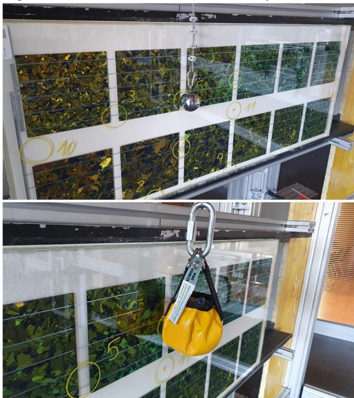
Figura 24 – Pêndulo e esferas utilizadas para os testes
