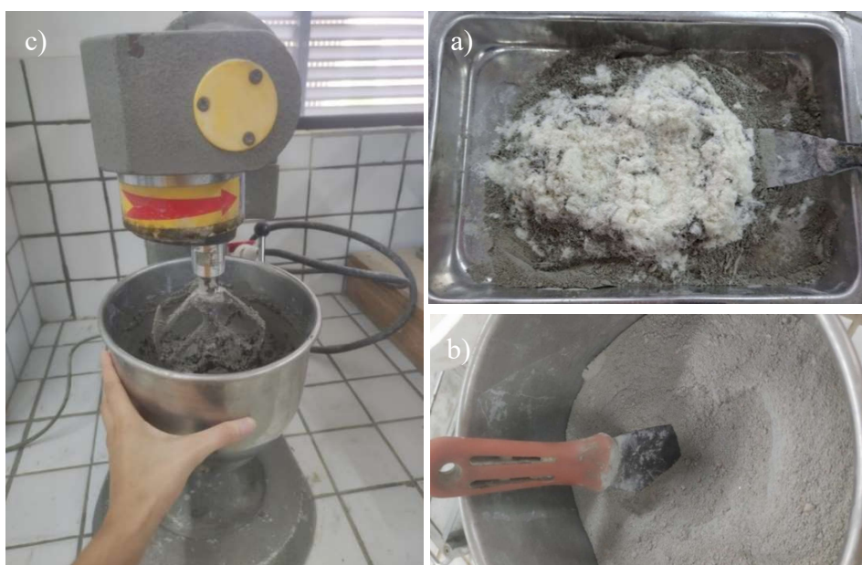
Figura 7 - (a) Preparação das argamassas. (b) Mistura dos materiais secos. (c) Homogeneização na argamassadeira.
