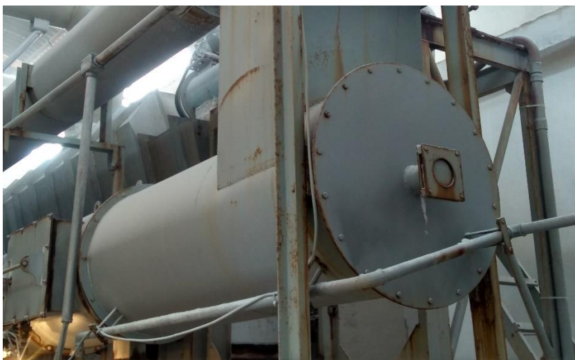
Figura 13 - Forno responsável por aquecer o secador.
