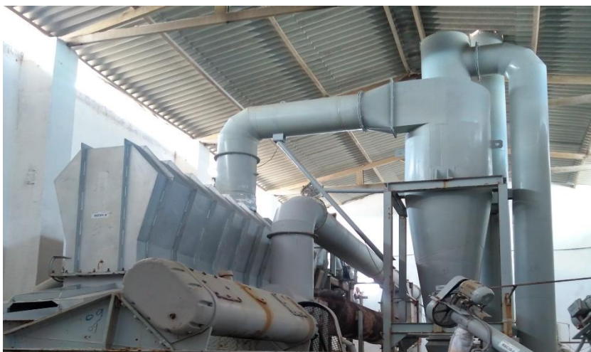
Figura 12 - Sistema secador de leito fluidizado e ciclone.
