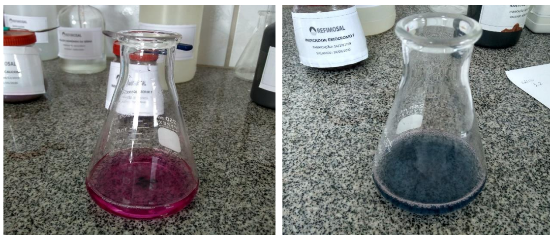
Figura 19 - Marcha analítica para determinação do teor de magnésio na amostra de sal. (a) Após a adição da solução tampão e indicador; (b) Após a titulação.
