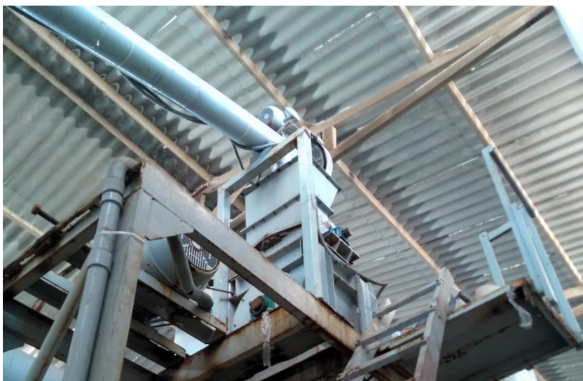
Figura 11 - Moinho de bolas e costelas utilizado no início do processo.
