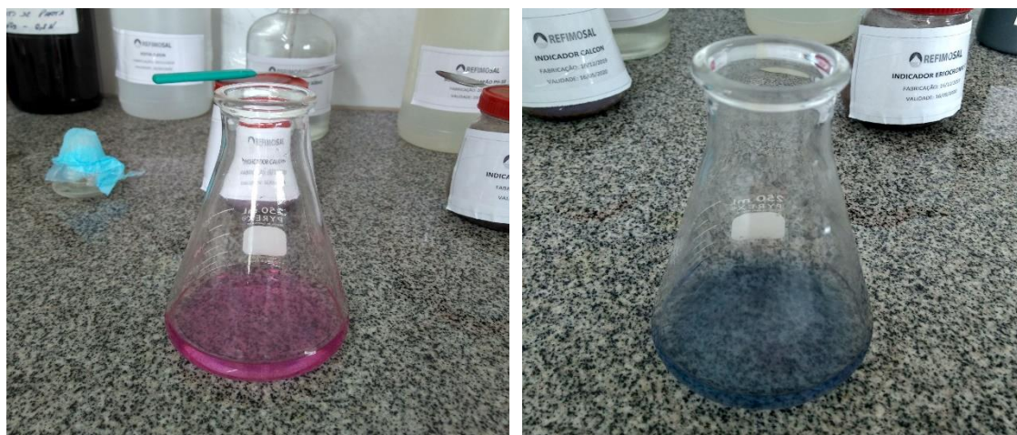
Figura 18 - Marcha analítica para determinação do teor de cálcio na amostra. À esquerda, temos a solução após a adição do hidróxido de sódio e o indicador calcon; (b) À direita, após a titulação com o EDTA.
