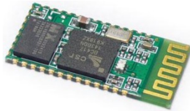
Figura 12 – Módulo bluetooth limpo sem placas de conexão, LED ou botão. Fonte: Itead Studio (2010)
