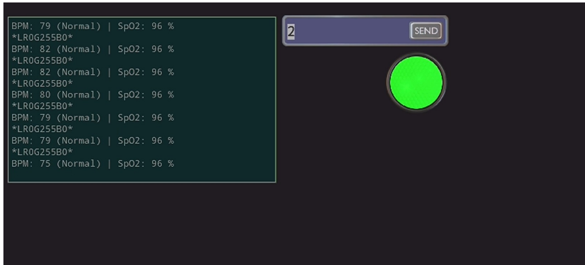
Figura 19 – Monitor Serial do Bluetooth Electronics mostrando BPM e SpO2 do MAX30102 com LED verde para valores corretos.
