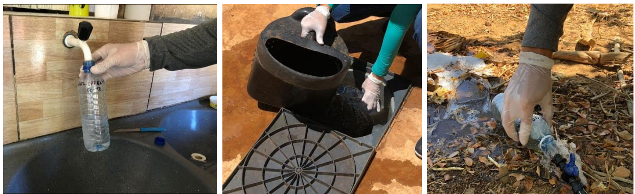
Figura 03- Locais dos pontos de coleta: (A) fonte de alimentação, (B) esgoto bruto e (C) efluente tratado
