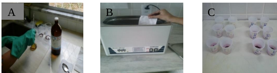
Figura 1- Procedimentos de pré-condicionamento das sementes de quiabo, cultivar Santa Cruz 47, para o teste de tetrazólio. Ácido sulfúrico (96%) (A); água quente (60 °C) (B) álcool etílico (98%) (C). Fonte: Dados da pesquisa.
