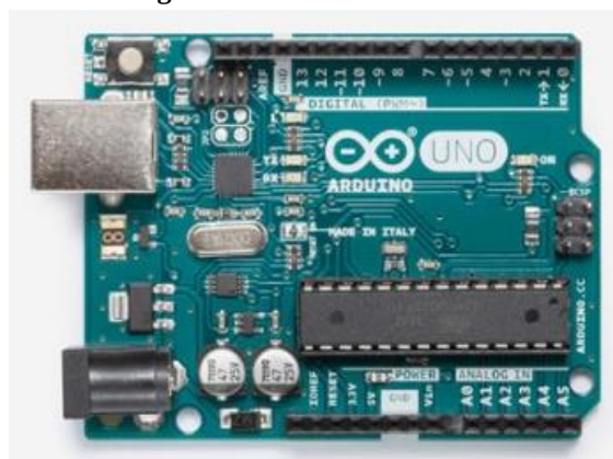
Figura 3 - Arduino Uno REV3
