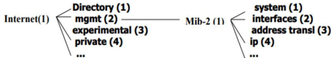
Figura 2 – Estrutura Hierárquica da MIB.
