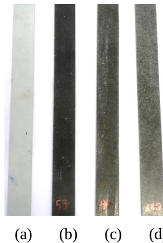
Figura 22: Corpos de prova (a) PRFV; (b) PRFV+ G_{53-90}^{10\%} ; (c) PRFV+ G_{90-180}^{10\%} e (d) PRFV+ G_{180-300}^{10\%} .
