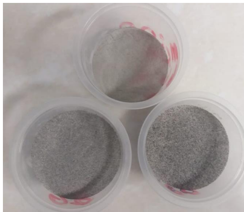
Figura 16: Pós de granito nas granulometrias de ( 53\mu\text{m} - 90\mu\text{m} ; 90\mu\text{m} - 180\mu\text{m} e 180\mu\text{m} - 300\mu\text{m} ).
